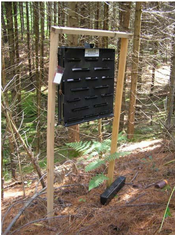
Theyson-ова баријерна клопка за мониторинг и сузбијање поткорњака
