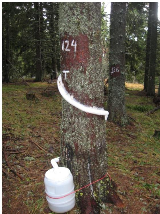
**Слика 36.** „Steamflow“ колектор на огледном пољу, БИТ Ниво 2, Копаоник
