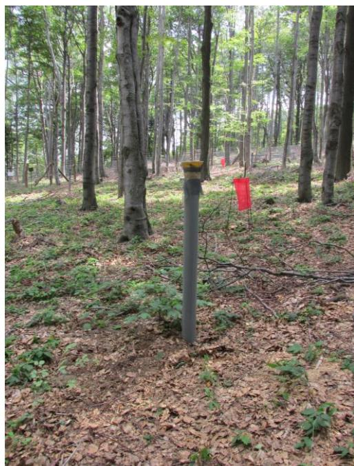
**Слика 37.** „Throughfall“ колектор на огледном пољу, БИТ Ниво 2, Црни врх
