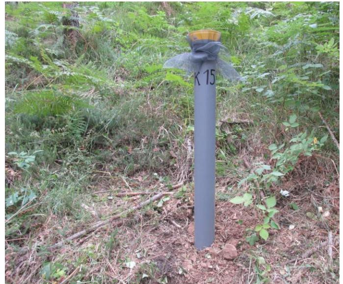
**Слика 40.** „Throughfall“ колектор на огледном пољу, БИТ Ниво 2, Мокра Гора
