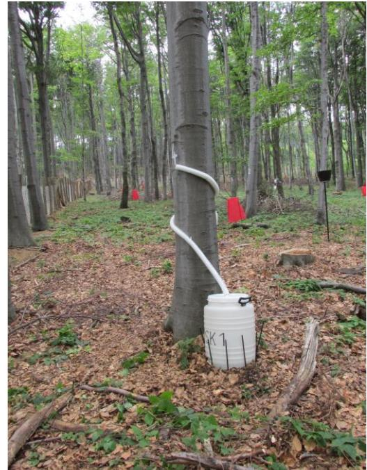
**Слика 38.** „Steamflow“ колектор на огледном пољу, БИТ Ниво 2, Црни врх
