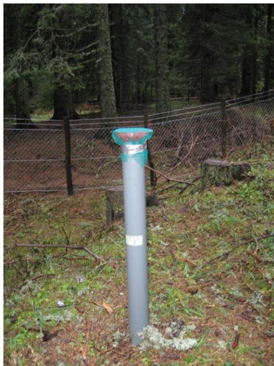
**Слика 35.** „Throughfall“ колектор на огледном пољу, БИТ Ниво 2, Копаоник
