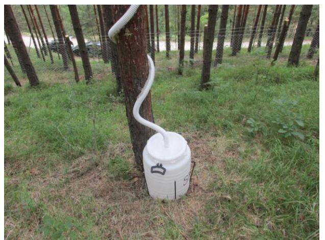
**Слика 42.** „Steamflow“ колектор на огледном пољу, БИТ Ниво 2, Мокра Гора
