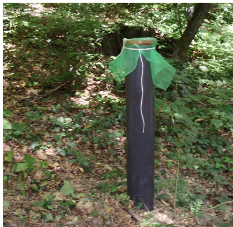
Слика 13. Колектор за «throughfall» депозицију падавина
