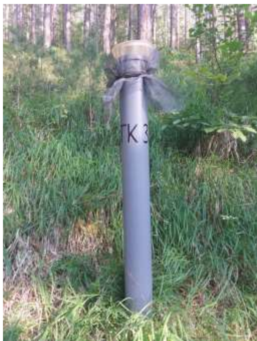
Слика 402. „Throughfall“ колектор на огледном пољу, БИТ Ниво II, Мокра Гора, 2018. година Figure 402. `Throughfall` collector on the sample plot, Level II, Mokra Gora, 2018
