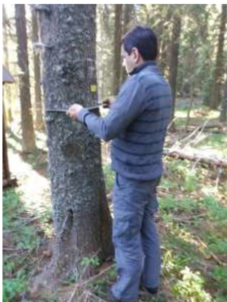
Слика 418. и 419. Мерење пречника стабла, постављање механичког дендрометра и провера Figure 418. and 419. Tree diameter measurement, a mechanical dendrometer setting and checking
