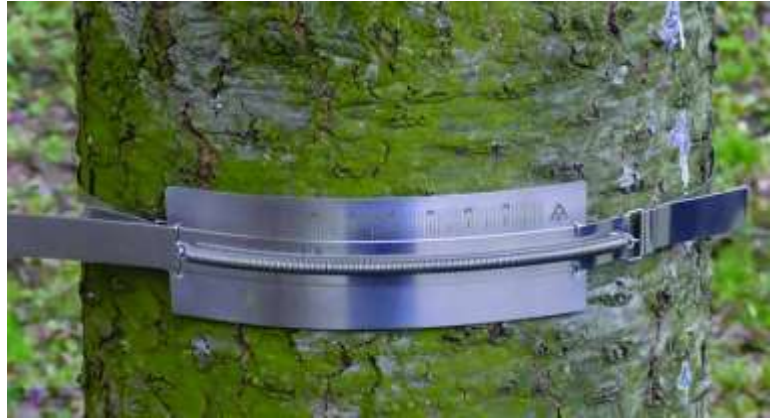
Слика 440. Мањуелни дендрометар Figure 440. Manual dendrometer
