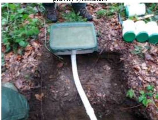
Слика 409. Уградња гравитационог лизиметра у чело земљишног профила Figure 409. Installation of a gravity lysimeter into the head of the soil profile
