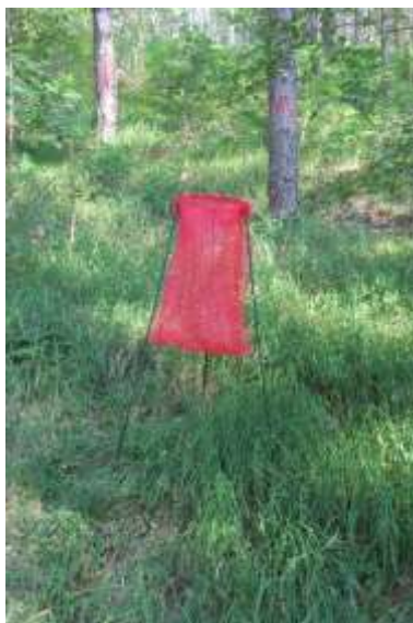
Слика 398. Колектор за сакупљање четина – лисног опада БИТ Ниво II - Мокра Гора Figure 398. Litterfall collector, Level II SP, Mokra Gora
