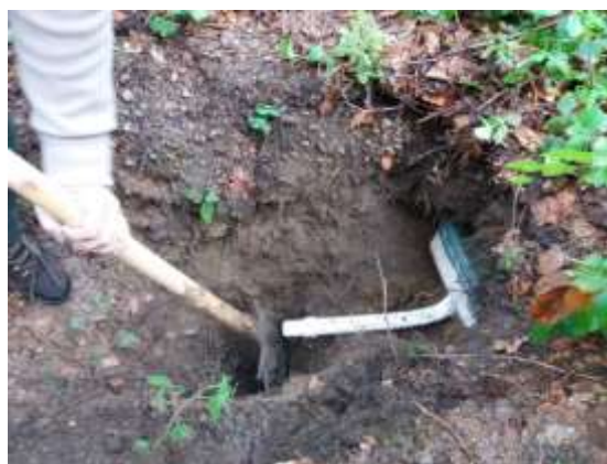
Слика 409. Уградња гравитационог лизиметра у чело земљишног профила Figure 409. Installation of a gravity lysimeter into the head of the soil profile
