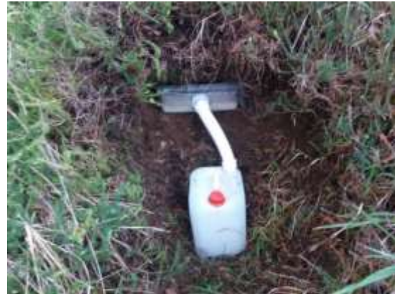
Слика 411. Инсталиран лизиметар са колектором за земљишни раствор Огледно поље БИТ НИВО II - Мокра Гора Figure 411. The installed lysimeter with a soil solution collector , Level II sample plot – Mokra Gora
