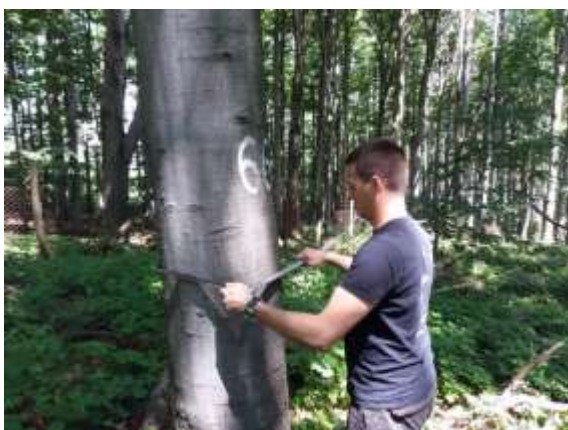
Слика 421. и 422. Мерење пречника стабла и постављање механичког дендрометра Figure 421. and 422. Tree diameter measurement and a mechanical dendrometer setting
