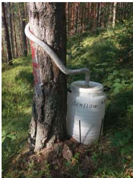
Слика 403. „Stemflow“ колектор на огледном пољу, БИТ Ниво II, Мокра Гора 2018. година Figure 403. `Stemflow` collector on the sample plot, Level II, Mokra Gora, 2018
