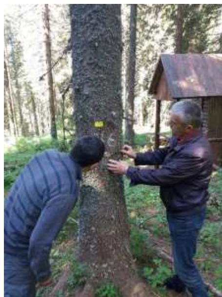
Слика 418. и 419. Мерење пречника стабла, постављање механичког дендрометра и провера Figure 418. and 419. Tree diameter measurement, a mechanical dendrometer setting and checking
