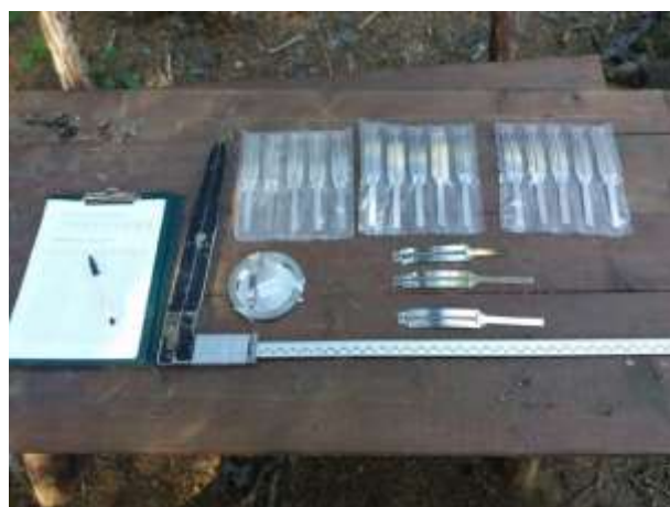
Слика 416. и 417. Опрема (механички дендрометри) спремна за уградњу на огледном пољу „Копаноник“ Figure 416. and 417. Equipment (mechanical dendrometers) ready to be installed on `Копаноник` sample plot
