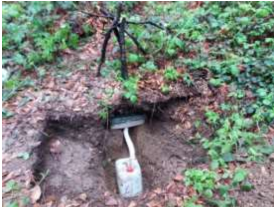
Слика 410. Инсталиран лизиметар са колектором за земљишни раствор Огледно поље БИТ НИВО II - Црни Врх Figure 410. The installed lysimeter with a soil solution collector , Level II sample plot - Crni Vrh
