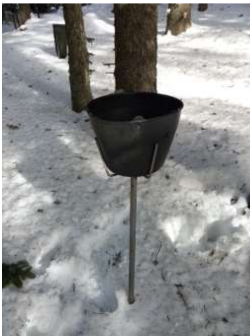
Слика 404. „Bulk“ колектор на огледном пољу, БИТ Ниво II, Копаоник 2018. година Figure 404. `Bulk` collector on the sample plot, Level II, Mokra Gora, 2018
