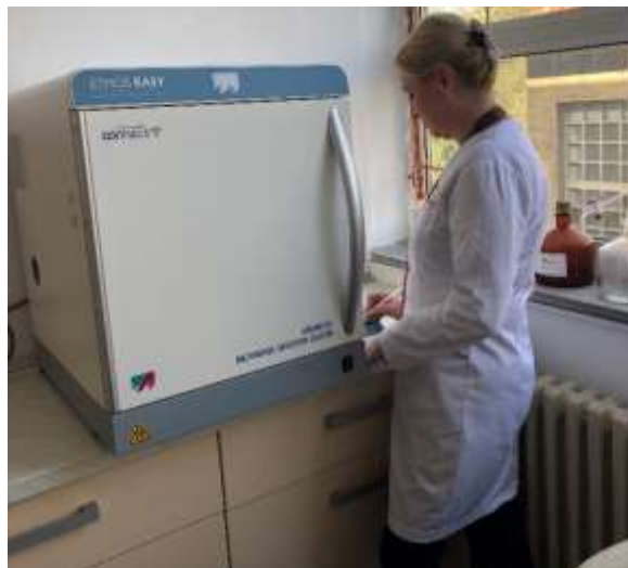
Слика 400. Припрема узорака у микроталасном дигестору Ethnos Easy – T480 за Копаоник, Црни Врх и Мокру Гору у лабораторији Института за шумарство, Београд Figure 400. Preparation of samples in Ethnos Easy - T480 microwave digester for Kopaonik, Crni Vrh and Mokra Gora in the laboratory of the Institute of Forestry, Belgrade
