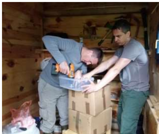
Слика 408. Израда гравитационог лизиметра Figure 408. Gravity lysimeter construction
