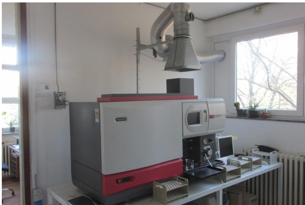
Слика 446. Одређивање количине хранљивих материја у лисном опаду (биланс кружења хранљивих материја у екосистему) за Копаоник, Црни врх и Мокру Гору ICP – AES Spectrometer у лабораторији Института за шумарство, Београд Figure 446. Determination of the amount of nutrients in the litterfall (balance of nutrient cycling in the ecosystem) on Kopaonik, Crni Vrh and Mokra Gora ICP – AES Spectrometer in the Institute of Forestry Lab, Belgrade
