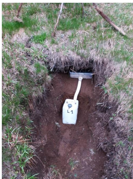
Слика 452. Инсталиран лизиметар са колектором за земљишни раствор Огледно поље БИТ НИВО 2 - Копаоник
