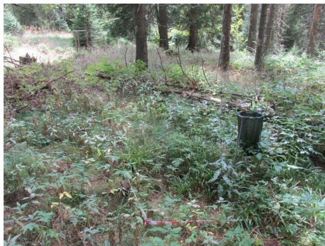
Слика 445. Колектор за сакупљање четина – лисног опада БИТ Ниво 2, Црни, врх август 2017 Figure 445. Litterfall collector, Level II SP, Crni Vrh, August 2017
