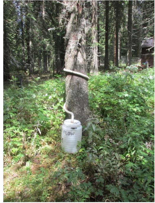
Слика 449. „Stemflow колектор“ на огледном пољу, БИТ Ниво 2, Копаноник, септембар 2017 Figure 449. `Stemflow` collector on the Level II sample plot on Kopaonik, September 2017
