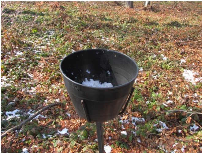
Слика 450. „Bulk“ колектор на огледном пољу, БИТ Ниво 2, Црни врх, 13.03.2017. Figure 450. `Bulk` snow collector on the Level II sample plot on Crni Vrh, March 13 th , 2017
