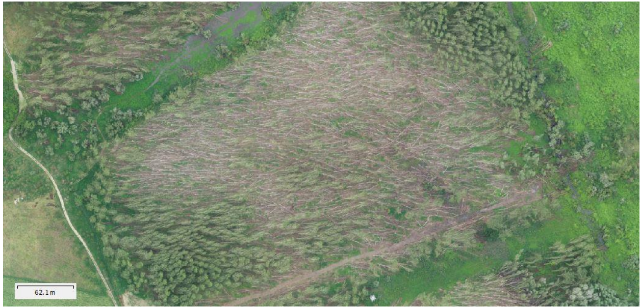
Слика 2. Део ортомозаика са штетом на преко 90% одељења у виду преломљених и савијених стабала
